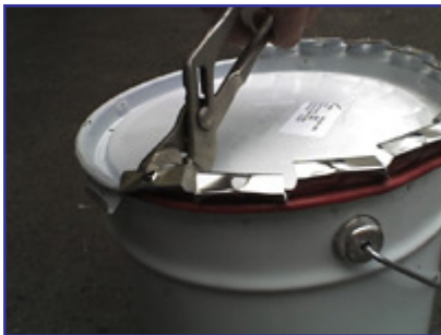
1.) Biegen Sie mit einer Rohrzange alle Blechlaschen des Deckels um 180° nach oben.
