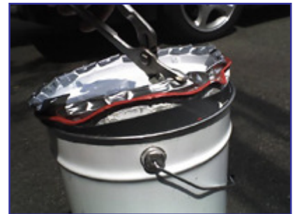
3.) Führen Sie den Schraubendreher zwischen Deckel und Eimerrand, hebeln Sie den Deckel aus, während Sie mit der Zange an den Blechlaschen ziehen.
