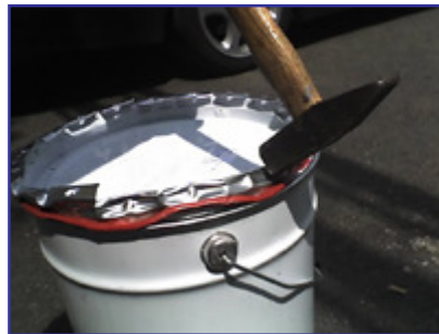
2.) Klopfen Sie von außen mit einem Hammer gegen die hochstehenden Blechlaschen.
